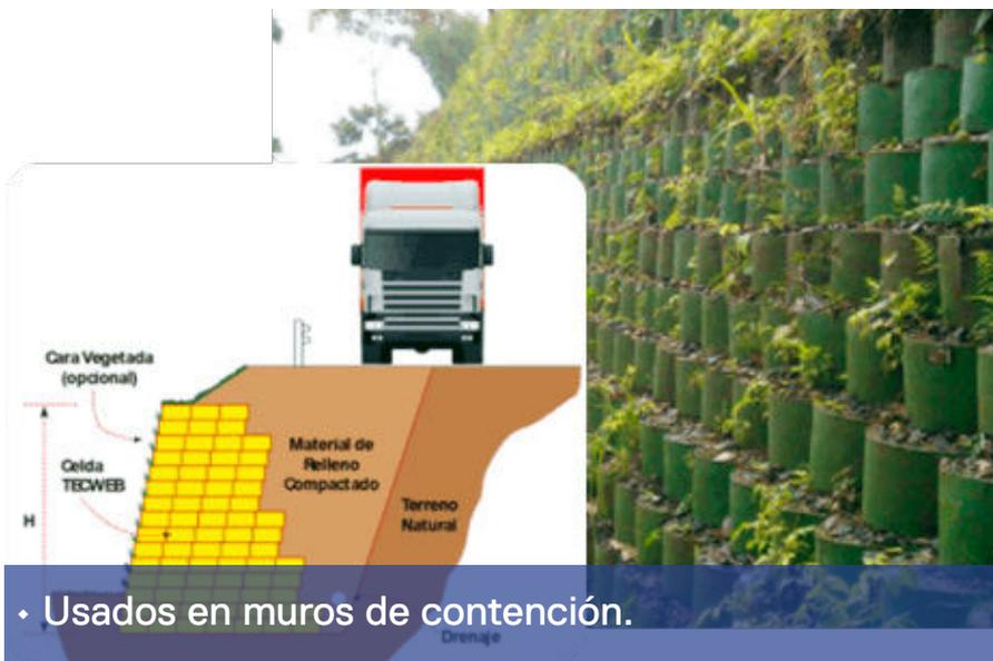
• Usados en muros de contención.
